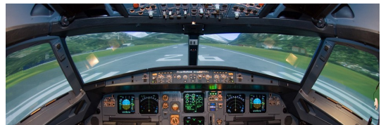
شکل ۱۴: نمای داخل کابین شبیه‌ساز پرواز هواپیمای A380 با دید و حرکت کامل [۱۸]
